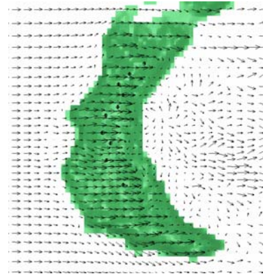
図1 ハブ高さにおける速度ベクトル
