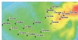
▲局所風況マップの作成および年間発電電力量(kWh)の評価例
