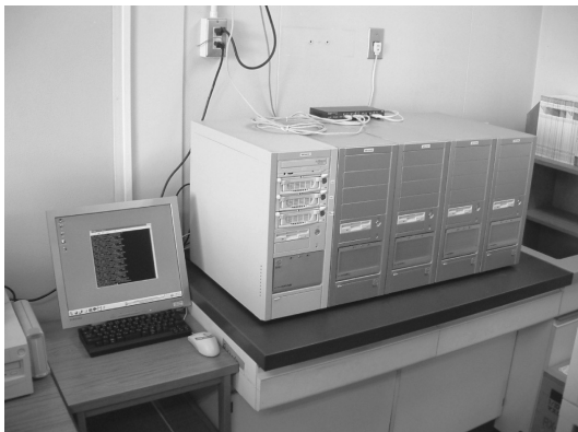
写真1 SCore型PCクラスタの概観写真
