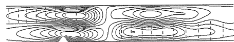
(a)一様流速Uからのずれを表わす流線図( \Delta\psi ), 最大値と最小値を15分割した等値線図
